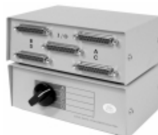
Commutatore seriale 4 vie A-B-C-D connettori femmina - D 25 poli Ref. 3-072-302
